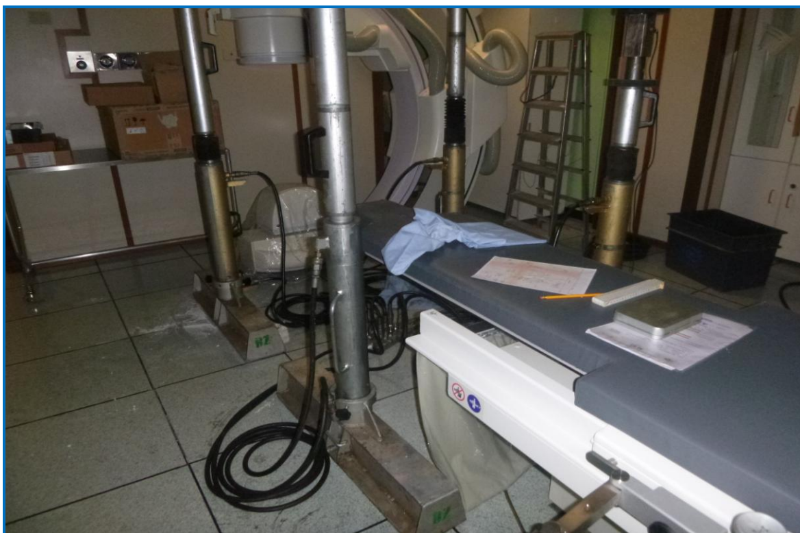
Vista del vecchio macchinario TAC e dei martinetti in estradosso del solaio in prova
