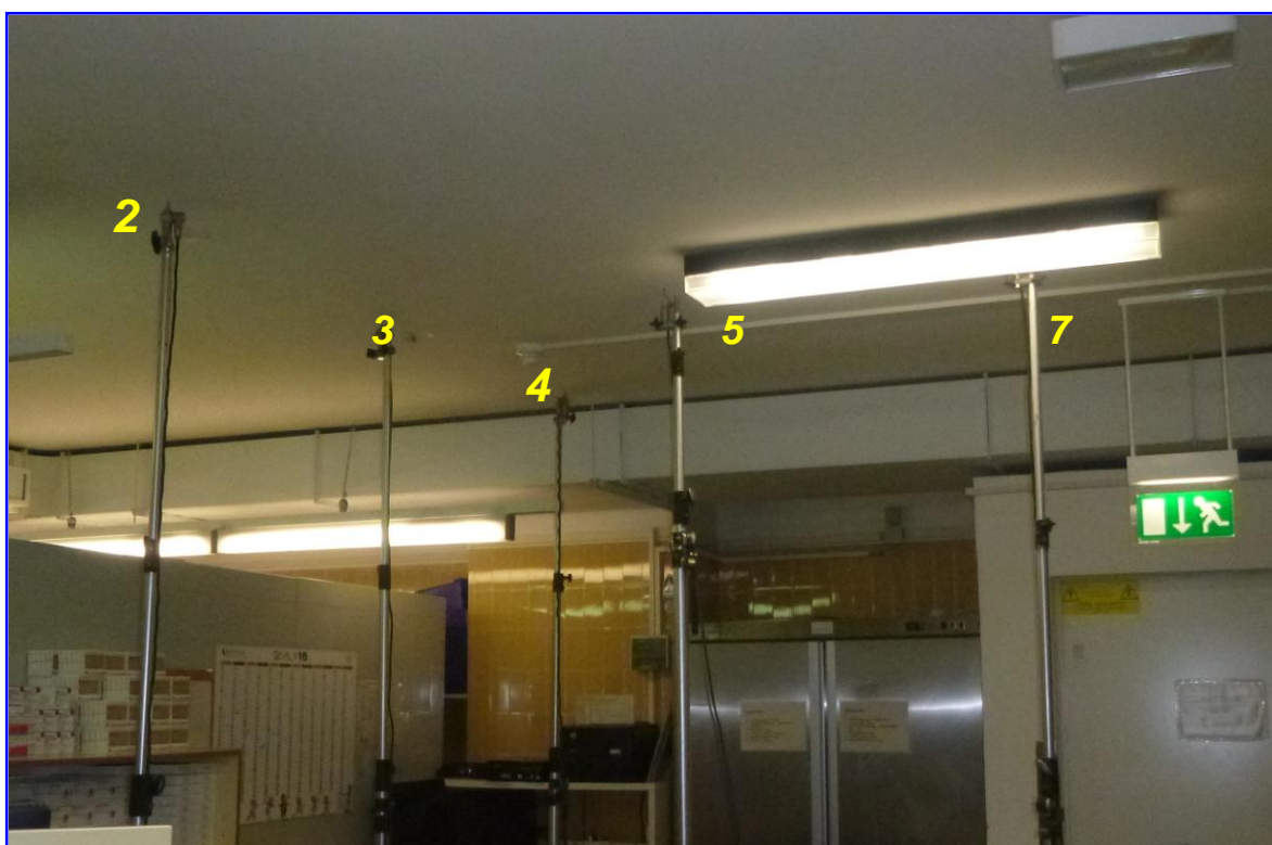
Sensori differenziali posti all'intradosso del solaio
